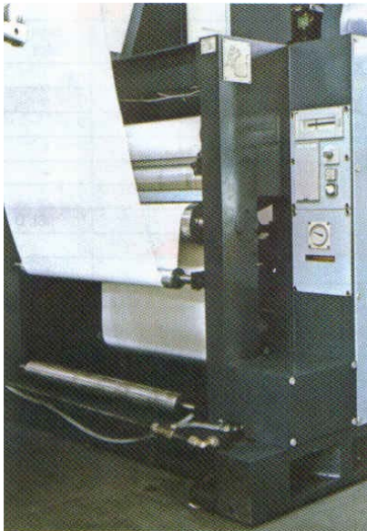
Slika : Naprava za natezanje papirnega traku
